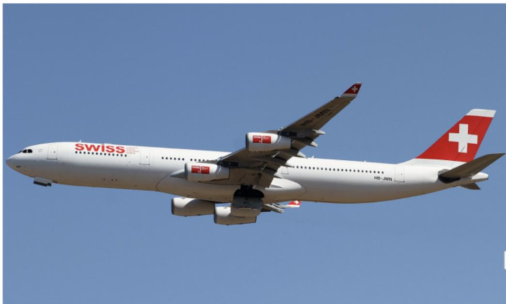
Figura: Avión Airbus A340 que puede volar siempre que al menos funcione un motor en cada ala.
