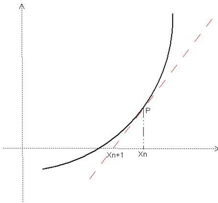
Figura 1: Método de Newton
