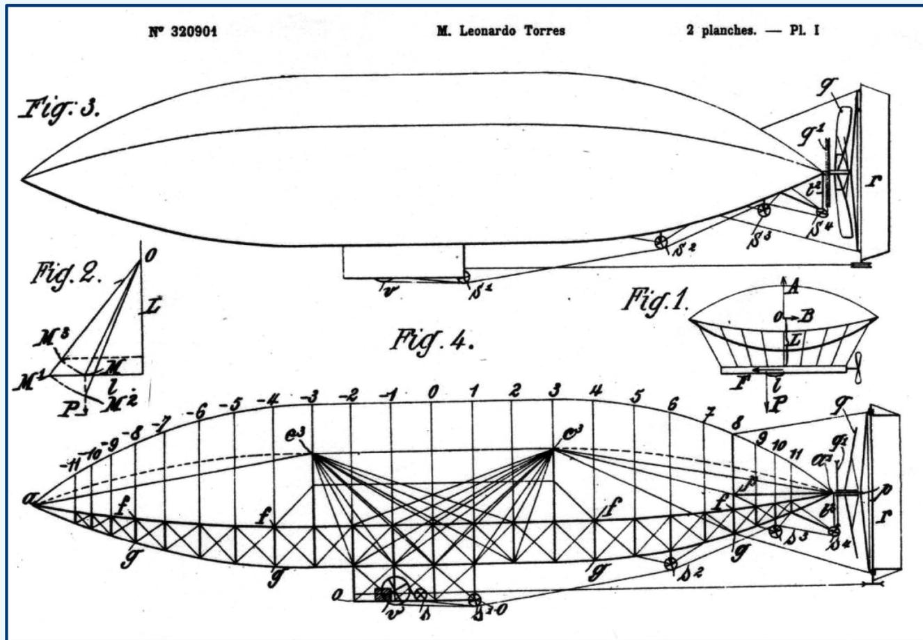
Su aportación ingenieril —gran novedad— consistió en introducir lo que en otros modelos sería el armazón —**la viga** metálica o de madera de los dirigibles semirrígidos— **en el interior del globo** (así la barquilla puede ser pequeña y estar próxima al globo).
