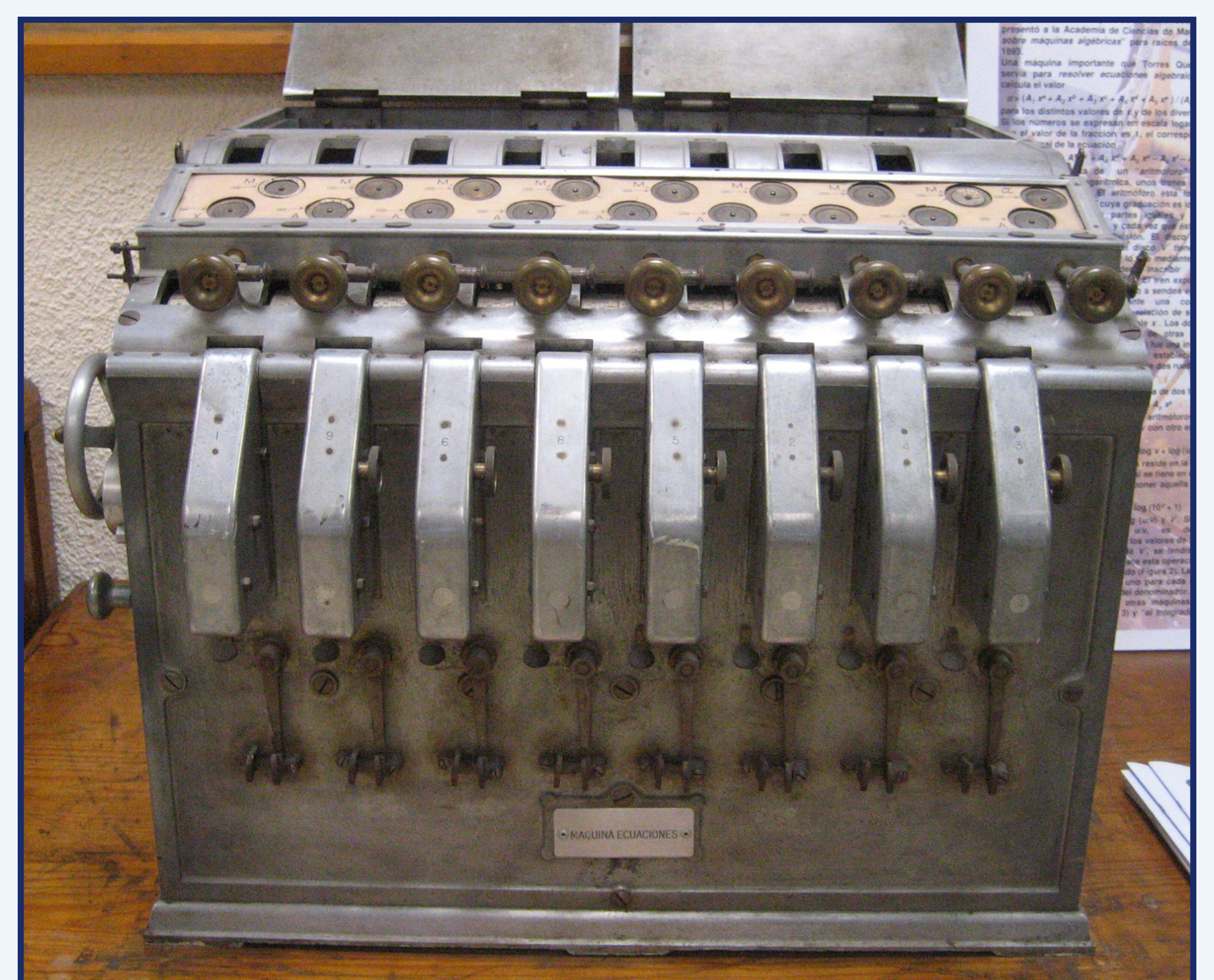
Máquina para resolver ecuaciones de ocho términos, c.1914
