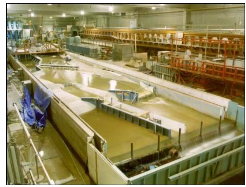
Figura 1.1: Modelo a escala de un cauce
