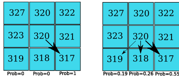
Figura 1.5: Distribución de flujo entre celdillas de un MDE de forma determinista y estocástica
