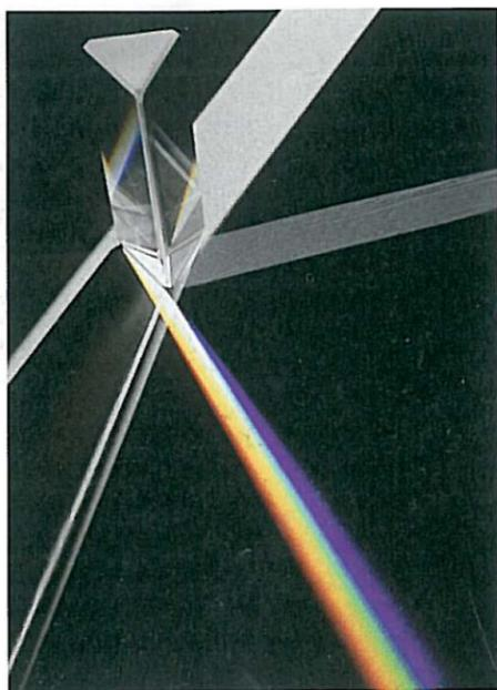
Cuando la luz blanca atraviesa un prisma, cada uno de sus colores se refracta de manera diferente. Por ello, los colores se observan separados.
