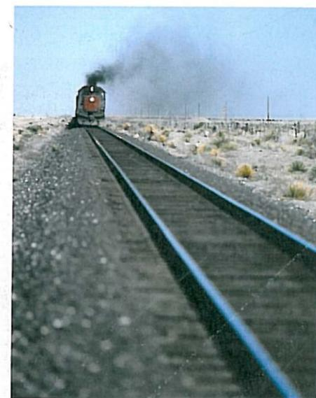
El sonido de un tren puede percibirse antes por los ralles que por el aire, ya que el sonido se transmite mucho más rápido por un sólido que por un gas.
