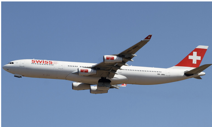
Figura 1.1: Avión Airbus A340 que puede volar siempre que al menos funcione un motor en cada ala.
