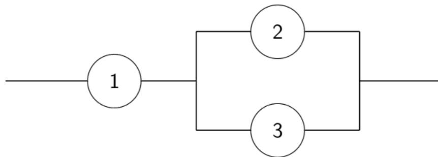
Sistema coherente con  $T = \min(X_1, \max(X_2, X_3))$ .
