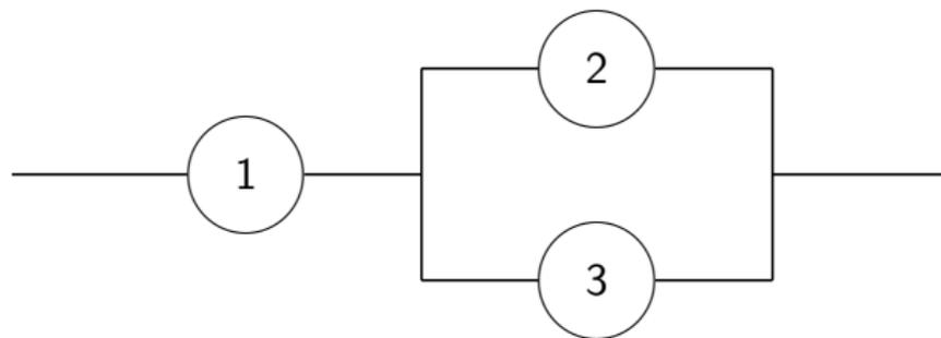
Sistema coherente con  $T = \min(X_1, \max(X_2, X_3))$ .
