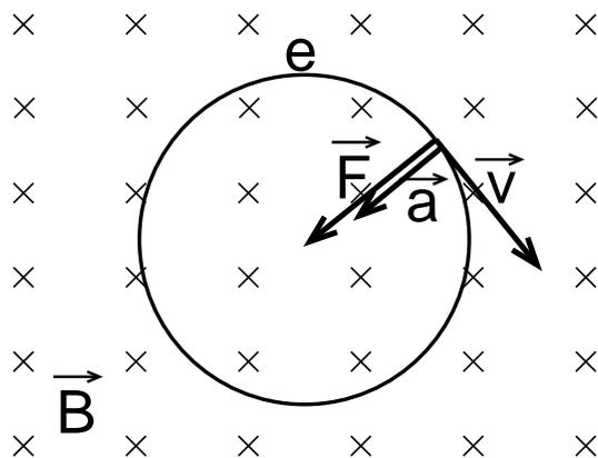
c) Una partícula de carga  $q$  y masa  $m$  que entra con velocidad  $\vec{v}$  en un campo magnético perpendicular a  $\vec{v}$  experimenta una fuerza de Lorentz de módulo  $qvB$  que provoca una aceleración normal  $mv^2/R$  que hace describir un círculo de radio  $R$ . Por tanto
