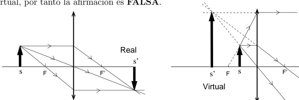
(En el trazado de rayos es suficiente dibujar solo 2 de los 3 rayos en cada figura).
