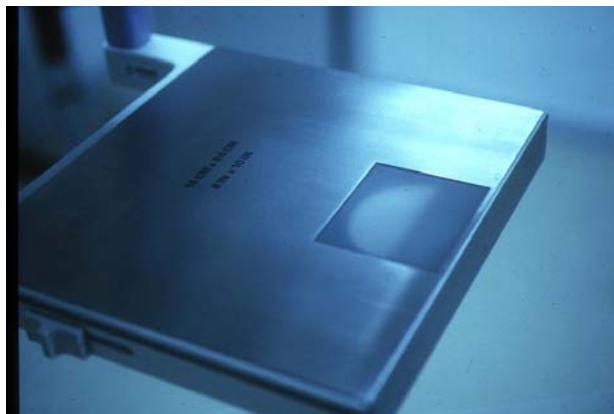
Fig. 6.12. Detalle de la ubicación de la cámara de exposimetría automática.
