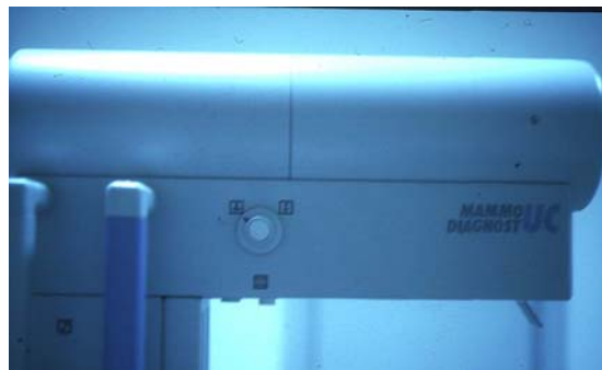
Fig. 6.6. Selección de la filtración en Mamografía.
