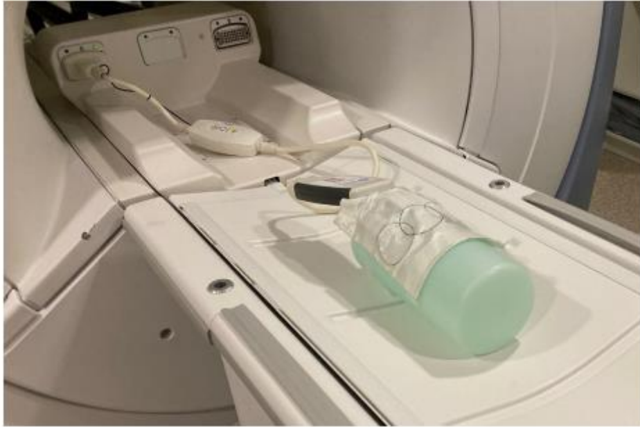
Figura 4. Conjunto de bobinas receptoras flexibles de 3 canales colocadas en el escáner de IRM en posición de uso normal.
