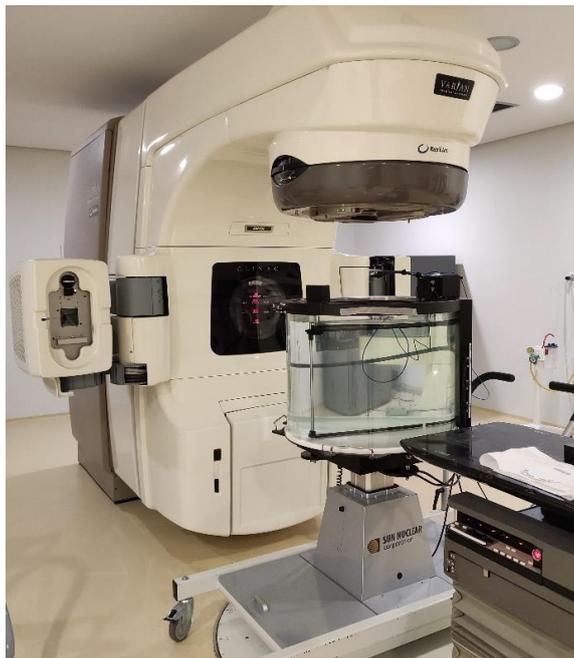
Figura 1 - Detalle del 3D-Scanner en el búnker de Radioterapia del Hospital IMED Elche listo para tomar medidas. @ Cortesía del autor
