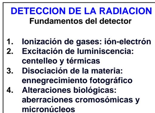
Fig.4.1.: Fundamentos de la detección de la radiación ionizante
