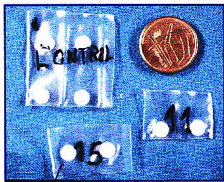
Cristales o dosímetros de TLDs para determinar las dosis de radiación en el paciente.
