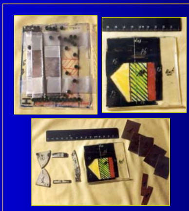
Fig. 1: Detalle de las diferentes partes que componen el filtro
