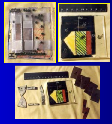
Fig. 1: Detalle de las diferentes partes que componen el colimador con filtración compensada.
