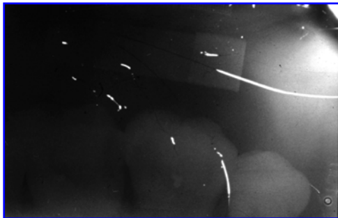
Fig.13.11.: Emulsión radiográfica arañada.
