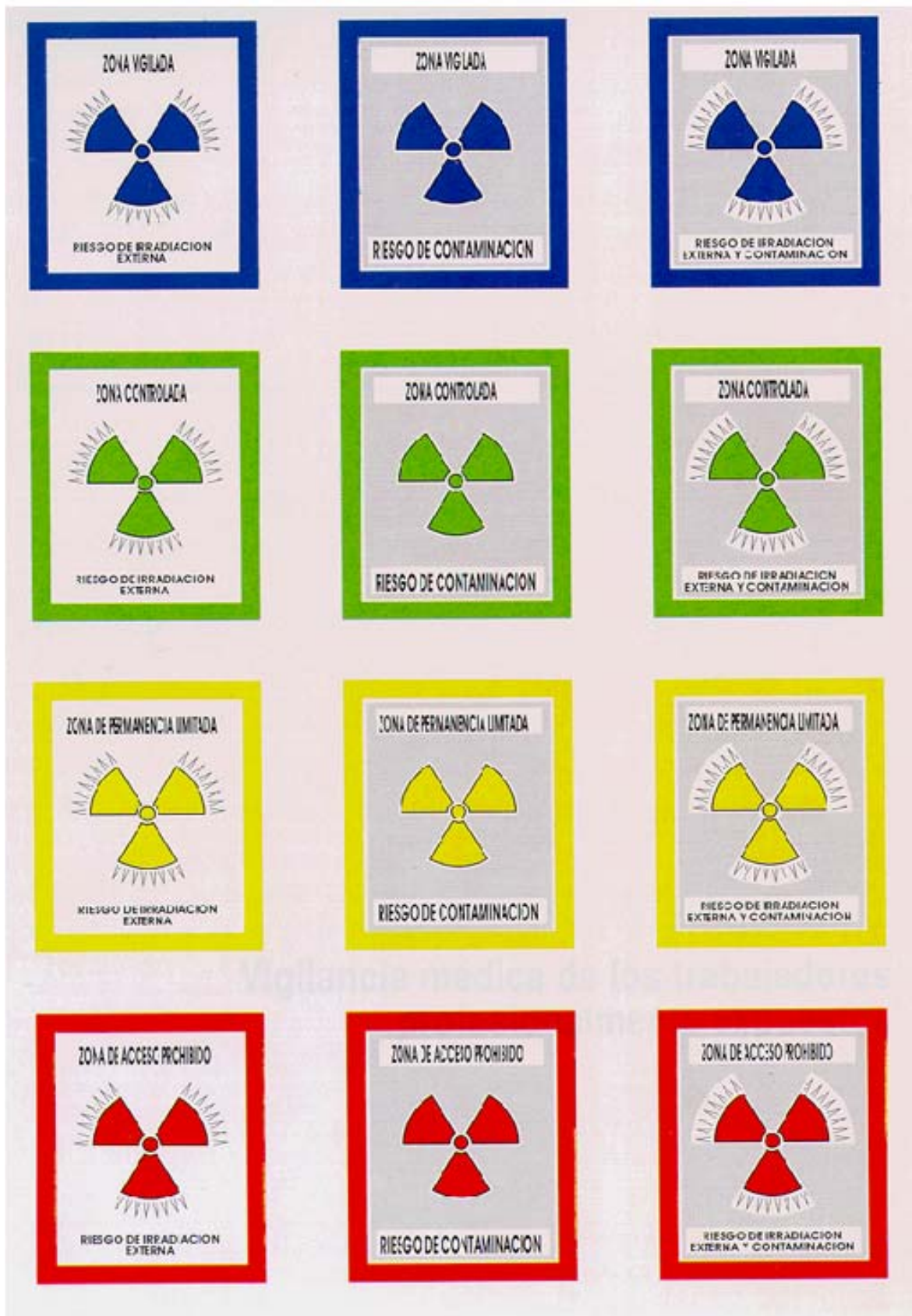
Fig.9.2.: Señalización de zonas con riesgo de irradiación
