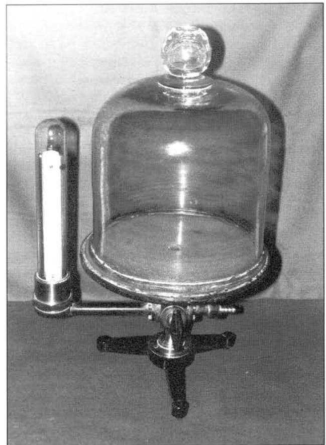
FIGURA 6. Bomba de vacío y campana de vacío conservadas en el Instituto Jorge Juan de Alicante.
