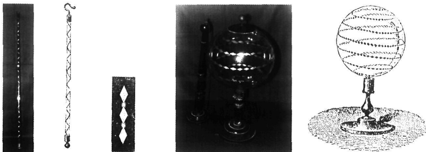
Figura 50. Tub centellejant (dues il·lustracions de l'esquerra). Detall dels rombes metàl·lics (centre). Esfera centellejant (dues il·lustracions de la dreta)
