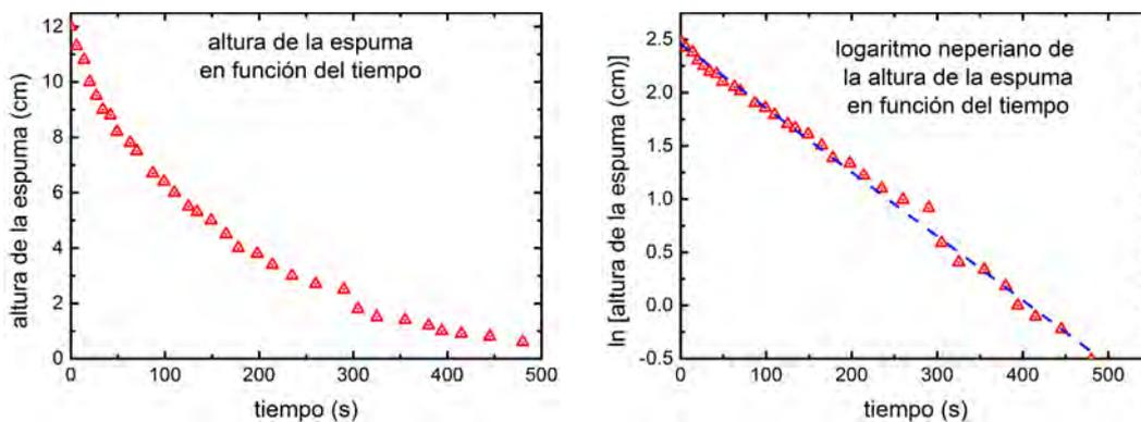
**Figura 3.** Evolución temporal de la altura de la espuma de cerveza, representada en escala lineal (izquierda) y en escala semilogarítmica (derecha). El valor negativo de la pendiente de esta última figura (0,006/s) sería el equivalente de la «constante de desintegración de la espuma de cerveza».
