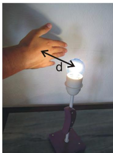
**Figura 1.** Cuando la mano nota una sensación térmica similar a la que notaría expuesta al sol, se anota la distancia  $d$  hasta el centro de la bombilla, de potencia  $P$ .
