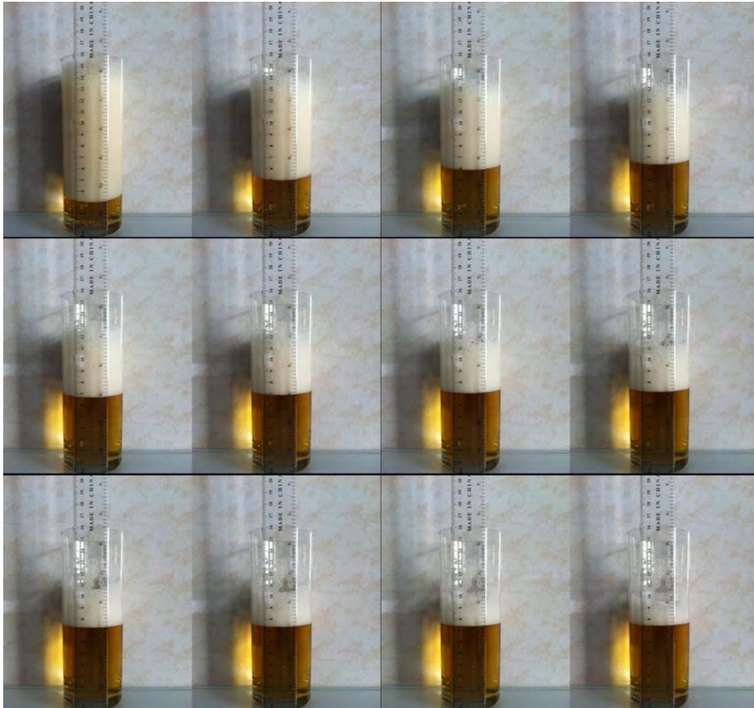
**Figura 2.** Fotogramas que muestran (comenzando por la esquina superior izquierda) cómo disminuye con el tiempo la altura de la espuma de cerveza. Las medidas se han realizado a intervalos regulares con una regla colocada junto al vaso.
