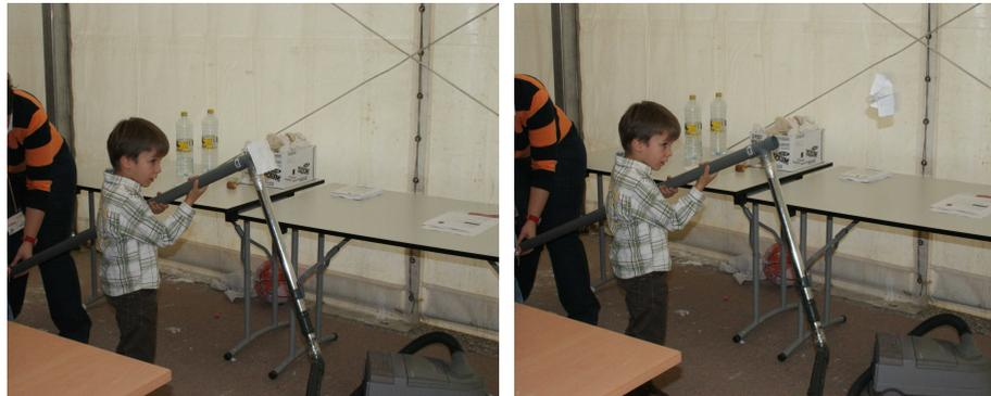
En este experimento producimos una diferencia de presión sobre un proyectil para lanzarlo a través de un tubo de PVC (de tubería); para ello, extraemos el aire de su interior con una aspiradora (como las que tenemos en casa). Si no colocamos el
