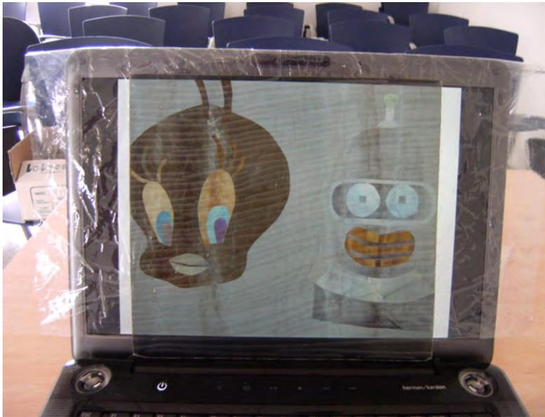
El campo eléctrico de la luz natural vibra en direcciones arbitrarias perpendiculares a la dirección de propagación. Sin embargo, la pantalla plana LCD de un ordenador emite *luz polarizada*, esto es, luz cuyo campo eléctrico vibra en una sola dirección. Esto es fundamental para el experimento, además de la naturaleza birrefringente del celofán.
