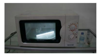
Un horno de microondas genera ondas estacionarias en su interior que provocan que los campos electromagnéticos sean más intensos en unas zonas que en otras. Esto hace que algunos gases (como los contenidos en las bombillas de neón o tubos fluorescentes) se ionicen produciendo un nuevo estado de la materia conocido como plasma, que al calentarse y enfriarse emiten luz visible.
