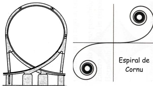
Empleando una clotoide se necesita una menor velocidad mínima en la parte superior que cuando el bucle es una circunferencia, por ello un acceso más lento al bucle todavía puede proporcionar suficiente aceleración centrípeta en la parte superior. De este modo, los viajeros sienten la "ingravedad" en la parte superior, pero la menor velocidad de acceso en la base hace que el viaje sea más confortable.
