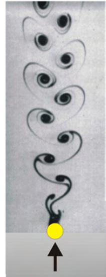
La figura adjunta representa la sección de una chimenea sobre la que sopla viento; los vórtices que se forman detrás de la chimenea son arrastrados por el aire y se van desprendiendo alternativamente a un lado y otro de la dirección del flujo. La forma que adoptan los vórtices tras el obstáculo se denomina "calle de vórtices de von Karman".
