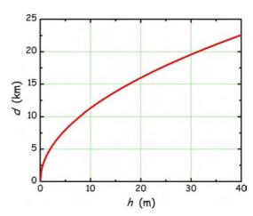
Si tomamos h=1.6 m para la altura a la que se hallan los ojos de una persona, entonces su horizonte se halla a una distancia  $d \simeq 4.5$  km. Esta distancia en línea recta desde el punto de observación hasta el horizonte coincide con el arco de circunferencia entre ambos lugares, pues el ángulo que subtienden es muy pequeño ( $\theta=\arctan(d/R)$ ), por lo que  $\theta R \simeq d$ .
